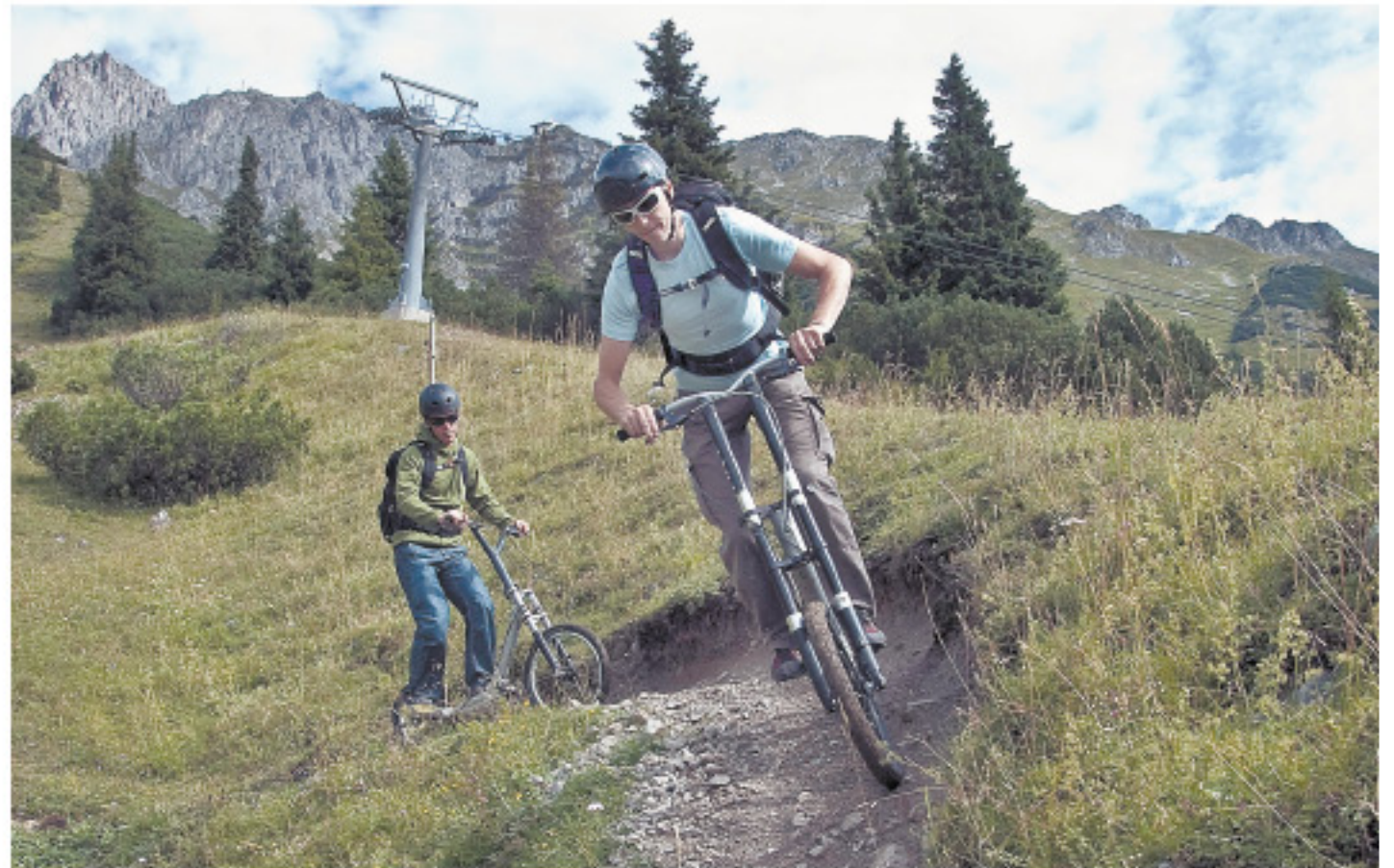
Die „Gams“ ist ein Roller für alpines Gelände, der mit mechanischen Scheibenbremsen und einer Federgabel ausgerüstet ist. Foto: B&B
